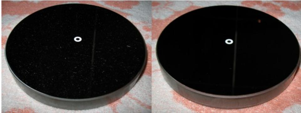
Risultato dell'operazione di pulizia dello specchio primario di un riflettore Newton 150 mm f/5
