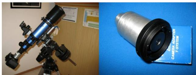
Configurazione per riprese in proiezione d'oculare
