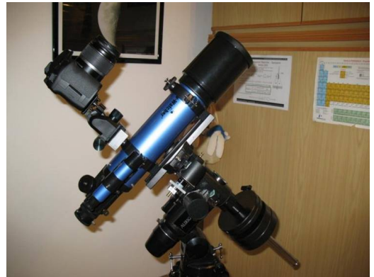
Configurazione per riprese in parallelo
