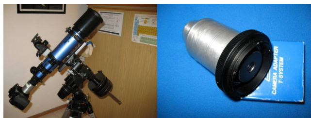
Configurazione per riprese in proiezione d'oculare
