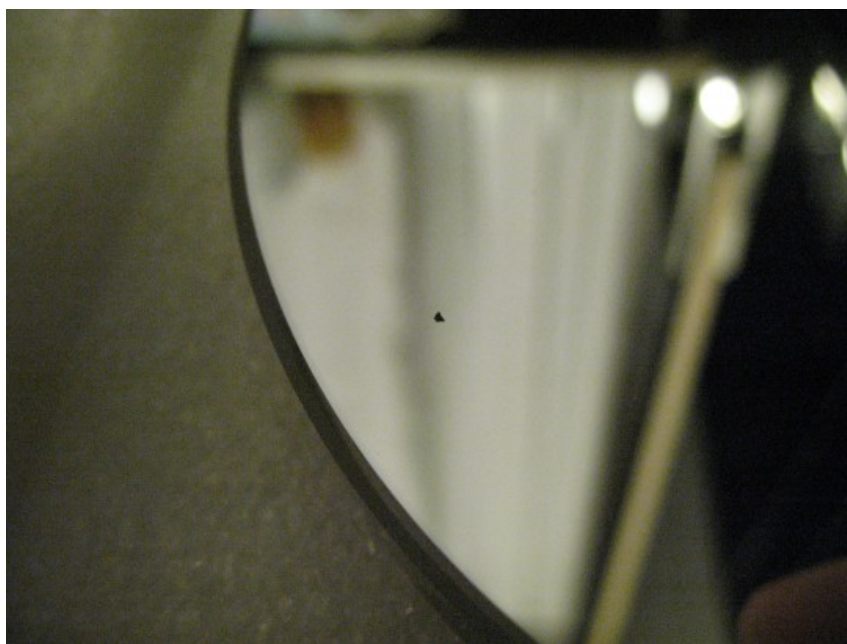
Figura 1 : Il piccolo granello di vernice nera depositata sullo specchio
