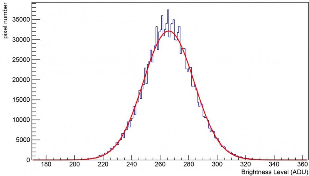
Figura 2: in azzurro la distribuzione dei Livelli di Luminosità di un sensore CCD in un bias frame. In rosso il risultato di un fit gaussiano della distribuzione. Ricordiamo che la larghezza della distribuzione del bias frame è spesso detta readout noise.
