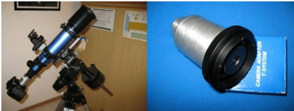
Figura 4.3: setup in configurazione “astrofotografia a fuoco indiretto”.
