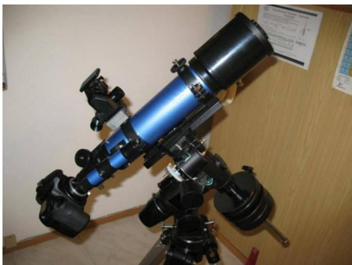
Figura 4.2: setup in configurazione "astrofotografia a fuoco diretto".
