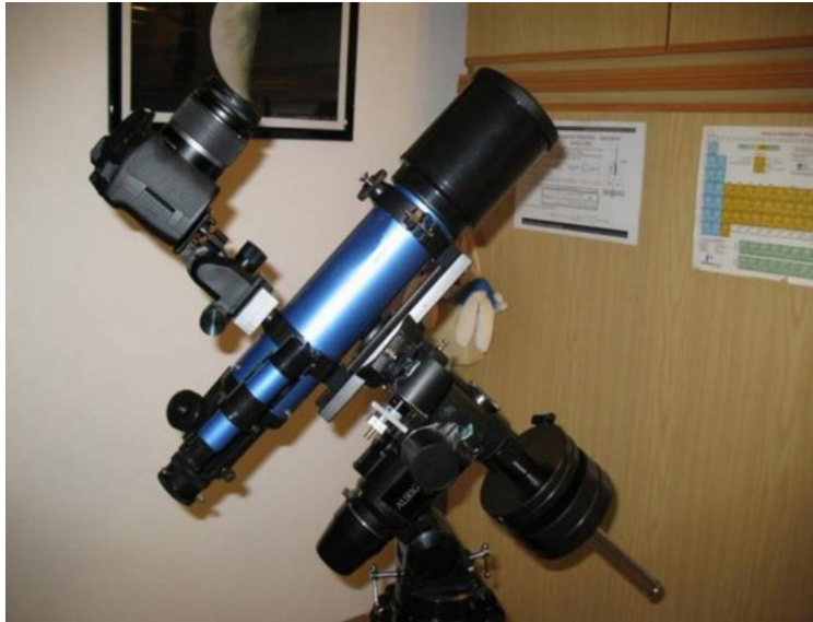
Figura 3.6: Setup in configurazione “astrofotografia in parallelo”.
