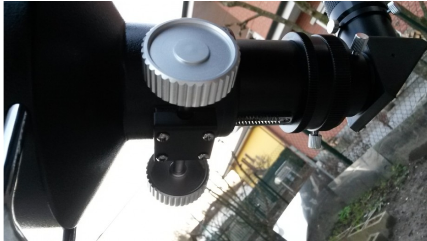
Figura 2: le quattro viti di regolazione del foceggiatore
