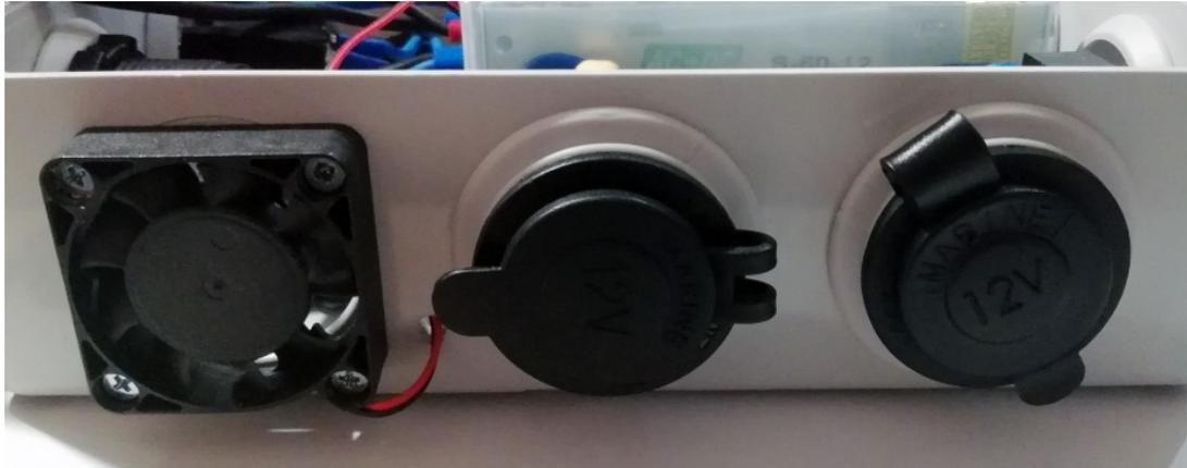
Figura 1: In figura sono visibili due dei tre accessi a 12V e la ventola di raffreddamento.
