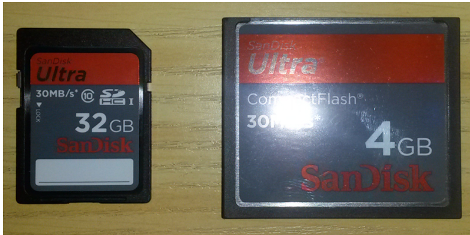
Figura 5: a sinistra una scheda di memoria SD, a destra un CF.
