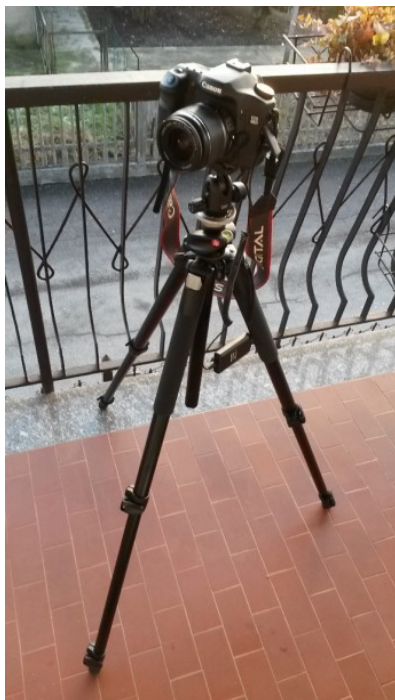
Figura 1: setup astrofotografico: corpo macchina, obiettivo, telecomando per scatto remoto, cavalletto fotografico.
