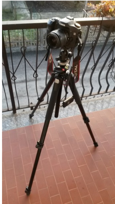
Figura 2: setup astrofotografico: corpo macchina, obiettivo, telecomando per scatto remoto, cavalletto fotografico.
