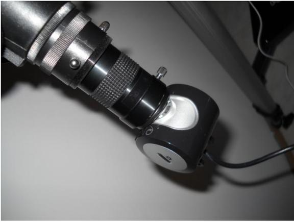
Esempio di webcam astronomica (una Philips SPC900NC modificata) applicata ad un telescopio.
