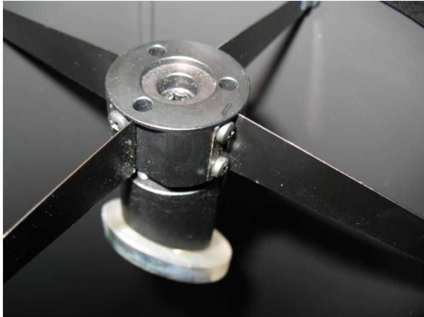
Figura 3 : Il sostegno dello specchio secondario
