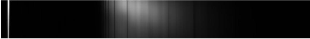
La stessa stella è stata ripresa con il medesimo setup anche il giorno 19/12/2012 ore 23.03 (TMEC). L'offset ottenuto tramite fit gaussiano è 31.4795 pixel. La massima luminosità è raggiunta per lunghezze d'onda pari a 5274.4 Å. [Scarica il file di testo della misura.](#)
