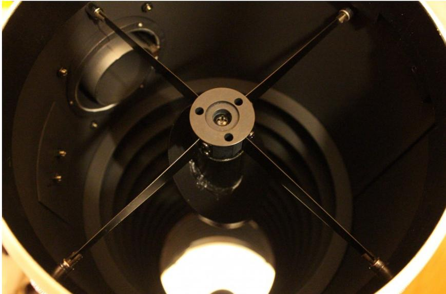
Il supporto del secondario. Lo specchio è stato smontato e fissato di nuovo al sostegno dalla ditta ARTESKY.
