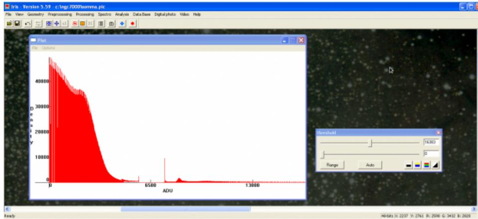
Immagine (eccessivamente) stretchata. Il segnale dopo il processo di stretching occupa praticamente tutto il range tonale.
