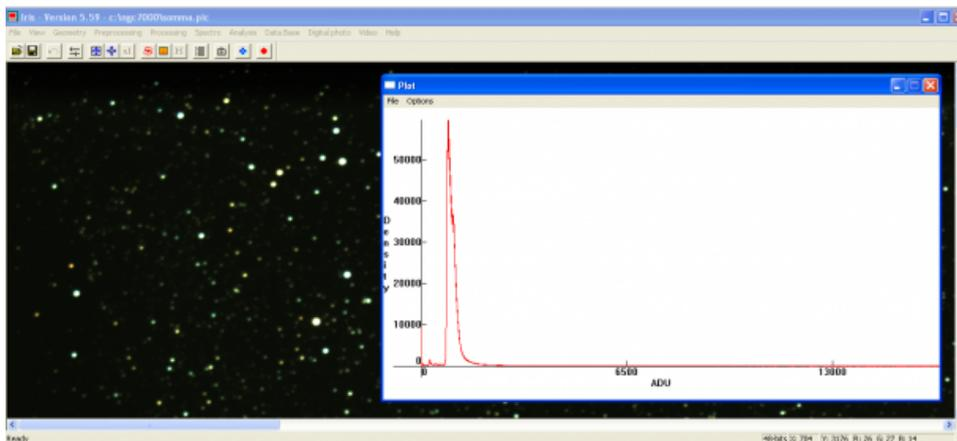
Istogramma di un'immagine a 14 bit in IRIS
