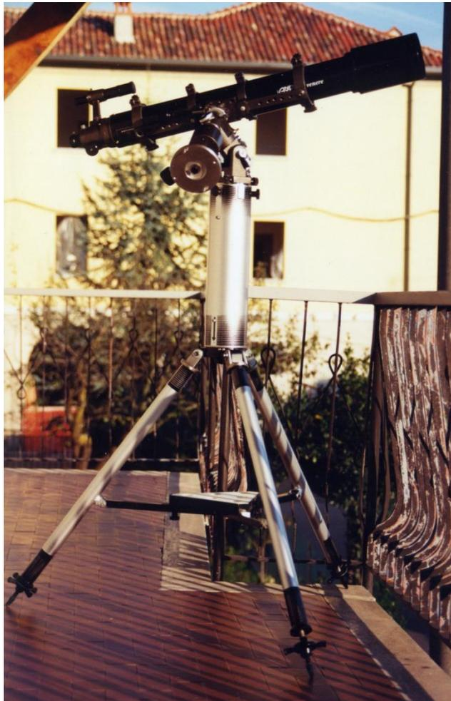
**Figura 2:** il rifrattore acromatico utilizzato per le riprese. Modello Antares Venere (anno 1998) diametro 100 mm f/10 su montatura New Polaris. Modifiche e motorizzazione in A.R. autocostruite.
